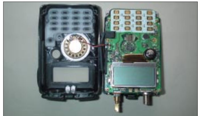
Die Oberseite der Digitalplatine mit der Mikrofonkapsel, im Gehäuseoberteil ist noch der winzige Lautsprecher. Fotos: DG1NEJ
