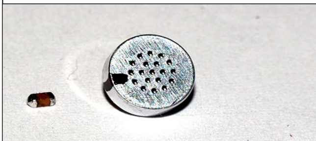
Las piezas retiradas del micrófono de mano. La capsula electret y el condensador SMD
